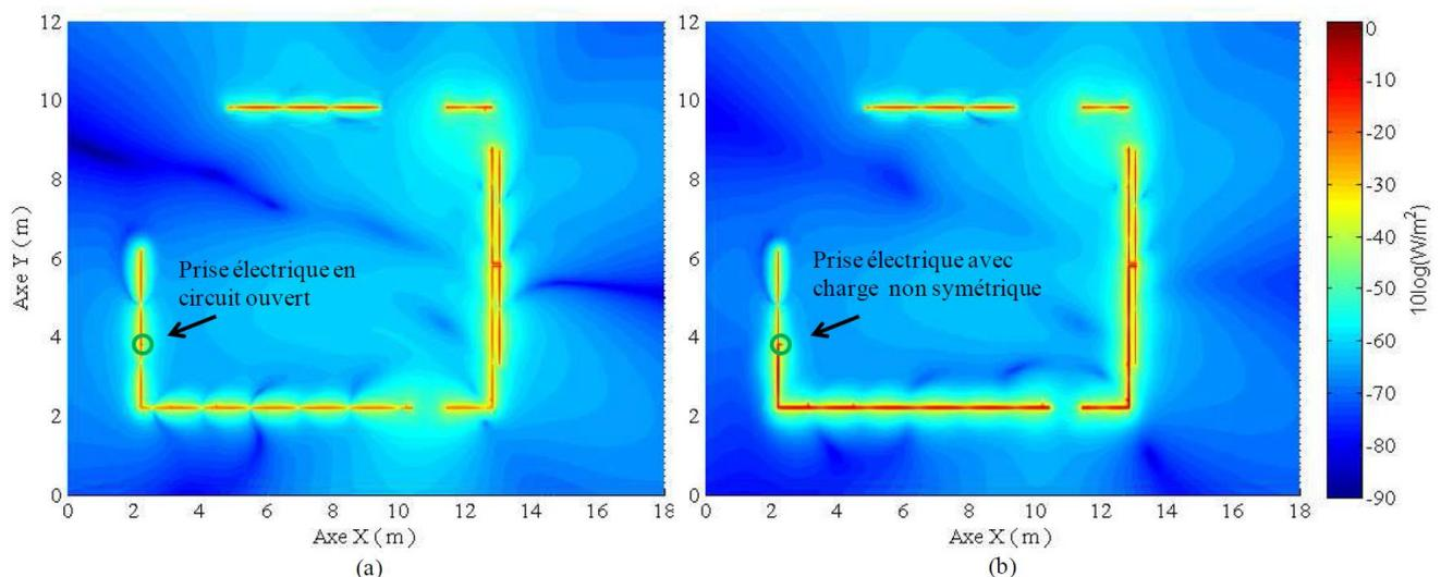
*(Ndlr : La modélisation du rayonnement en KHz du CPL dans une pièce d'une maison - ex. chambre par les câbles électriques. A gauche sans aucun appareil branché sur les prises, à droite avec un appareil branché donc une prise avec charge)*
